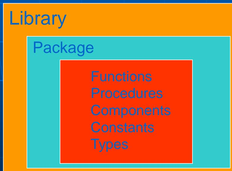
El código es escrito en forma de Funciones (Functions), Procesos (Process), Procedimientos (Procedures) ó Componentes (Components) y luego ubicados dentro de Paquetes (Packages) para ser compilados dentro de la Librería destino.
