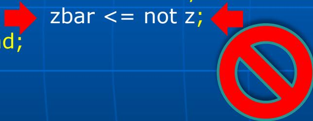
Así no puede ser usado 'z', para leer su estado y modificar a zbar, porque 'z' es una salida.
