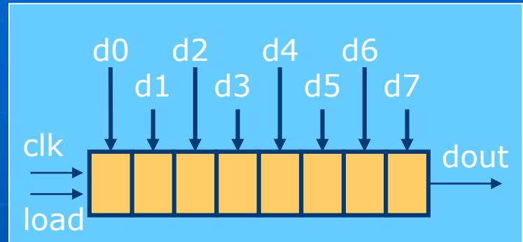
La carga del registro de desplazamiento es sincrónica ya que está dentro del proceso de control del flanco del reloj.
