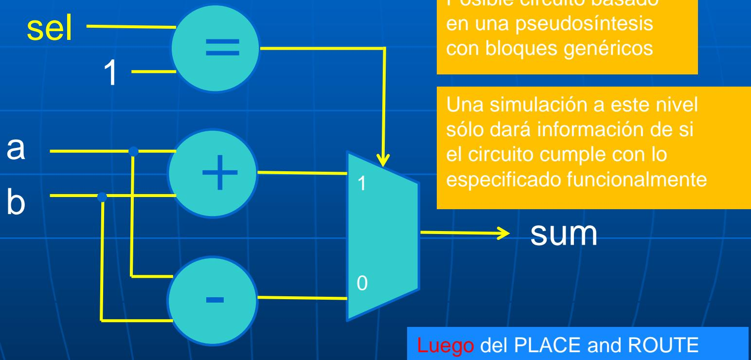
EN BASE A LOS RECURSOS QUE TENGA LA FPGA, A LA INTELIGENCIA DEL COMPILADOR Y EVENTUALES DIRECTIVAS DEL DISEÑADOR, SERÁ EL HARDWARE FINALMENTE IMPLEMENTADO. Aquí SI se tendrá información confiable del TIMING.
